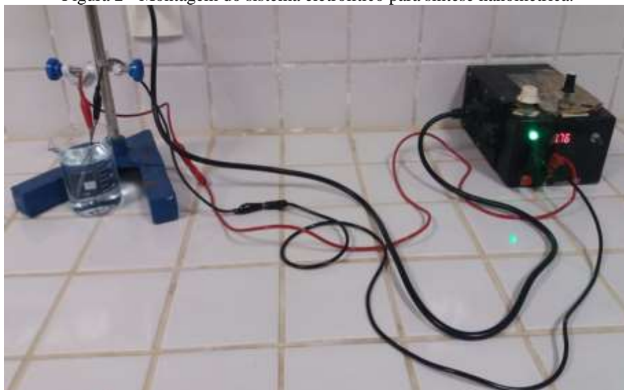
Figura 2 - Montagem do sistema eletrolítico para síntese nanométrica.
