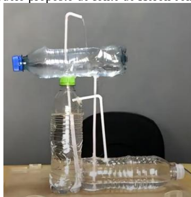
Figura 1 - Modelo proposto de fonte de Heron com garrafas PET.
