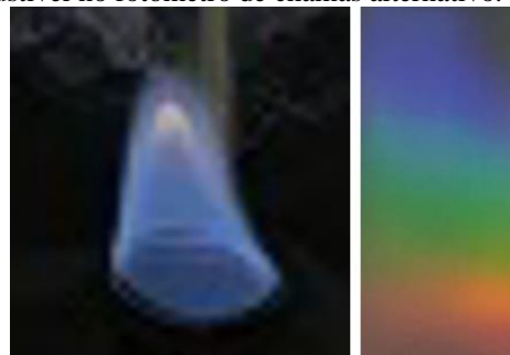
Figura 06 - Perfil da chama e espectro de emissão obtidos para a queima do etanol usado como combustível no fotômetro de chamas alternativo.
