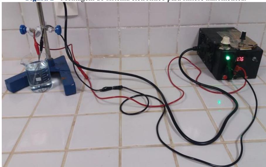
Figura 2 - Montagem do sistema eletrolítico para síntese nanométrica.
