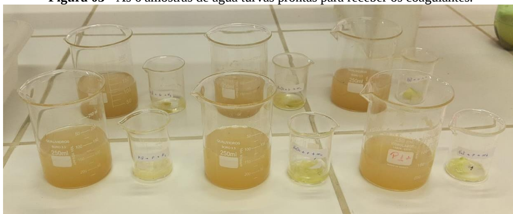
Figura 03 - As 6 amostras de água turvas prontas para receber os coagulantes.
