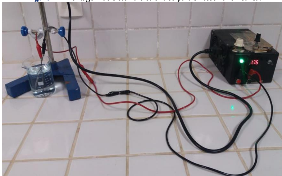
Figura 2 - Montagem do sistema eletrolítico para síntese nanométrica.
